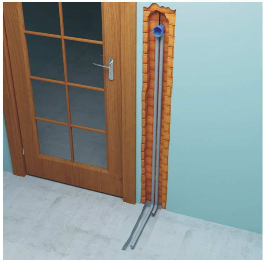
Монтаж гофрированных трубок
