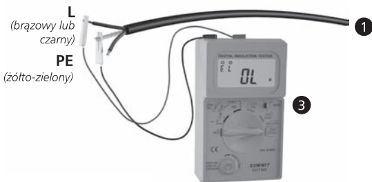
Pomiar rezystancji izolacji
